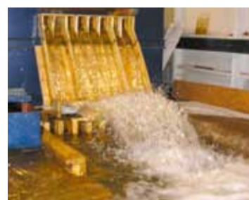
Сначала испытания проводили на мини-копии Бурейского водосброса: в лаборатории гидравлики ВНИИГ создали модель сооружения в масштабе 1:120.
