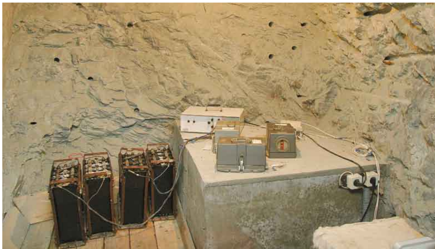
Специальные датчики установлены на скале рядом с Саяно-Шушенской ГЭС и фиксируют все отголоски землетрясений, зародившихся даже очень далеко от гидростанции.
